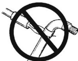
Les systèmes de tuyaux PEX ne doivent pas être intentionnellement soumis au gel. N'utilisez pas de chalumeau ou une chaleur excessive pour dégeler les tuyaux en PEX. Les tuyaux pourraient s'endommager ou faire défaut. La chaleur doit être appliquée directement à la section de tuyau qui est congelée. La température sur le tuyau ne doit pas excéder 85 °C (180 °F).
